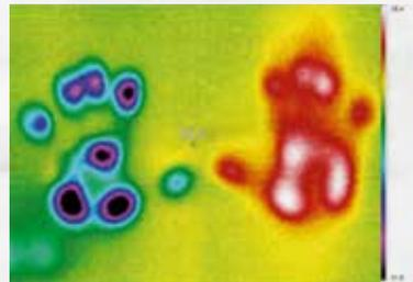
Es kann beobachtet werden, dass die Flachstapete die Wärme nicht an die Wand abgibt, sondern in sich aufnimmt. Sie wirkt somit isolierend.
